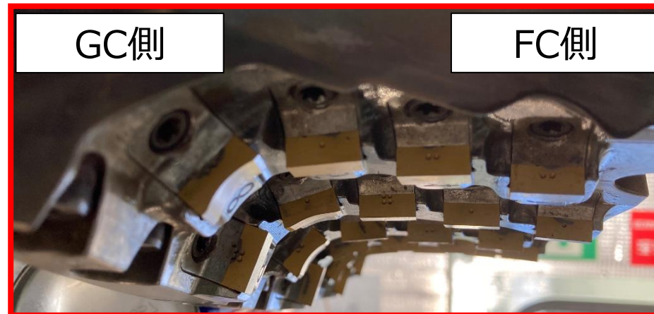
【ミリングチップ装着状態】 ※総数 1,152個 装着
