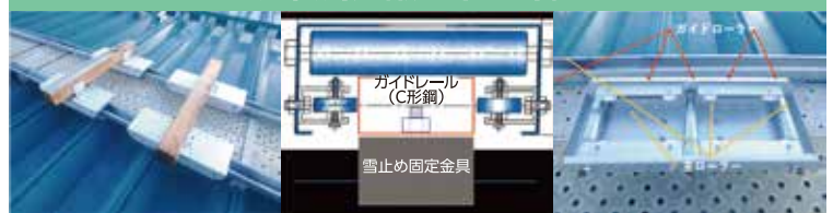
図2 運搬台車+レール
