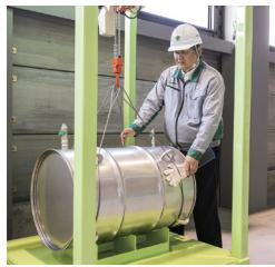
玉掛け作業中に吊り荷とワイヤーの間に手などが挟まれた場合の危険性を疑似手や竹筒などを使い体感する装置です。玉掛け時の吊上げ合図前の確認の重要性を学ぶことができます。
