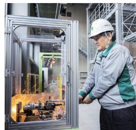
グラインダーを使用する際に起り得る壁や突起物に砥石が接触して弾かれる衝撃や、スイッチが入ったまま砥石が接地している状態で、電源プラグを差した際の急に暴れだして被災する危険性を学ぶことができます。
